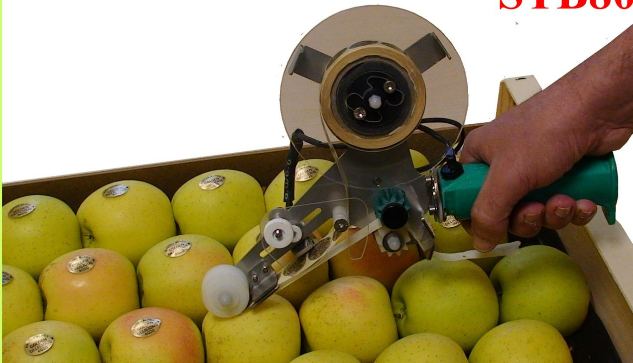
Étiqueteurs électriques sur batterie, manuels à grande vitesse **STB20**, **STB40** ou **STB80**, permettent la pose d'étiquettes autocollantes sur fruits ou tout autre support.
